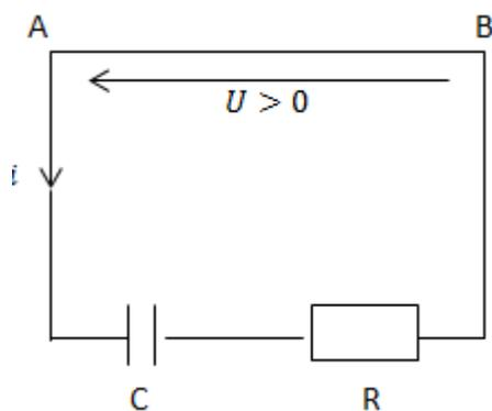
$R$  est la résistance du resistor et  $C$  la capacité du condensateur.  $R$  et  $C$  sont des constantes.
