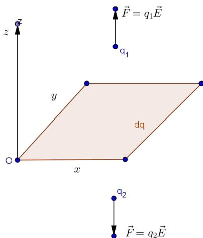
Symétrie de la force créée par une distribution surfacique de charge électrique
