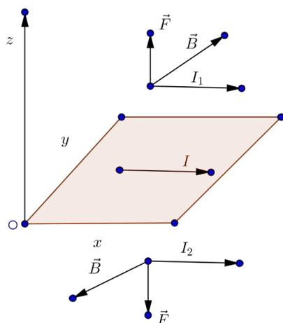
Symétrie de la force créée par une distribution surfacique de courant électrique
